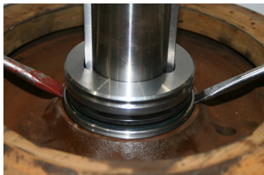
Ill. 14: Démontage de la garniture mécanique à l'aide de petits pieds de biche
